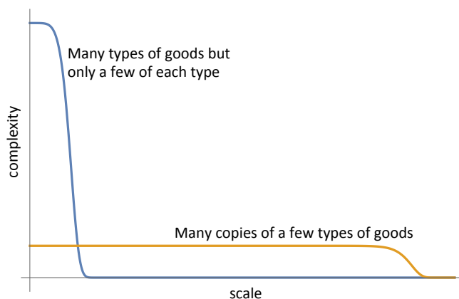
图 3. 工厂的复杂度曲线。可以选择产品种类少，但数量大的生产方式；也可以选择数量少但种类多的生产方式。前者是大规模（尺度）小复杂度，后者是小规模（尺度）大复杂度。
